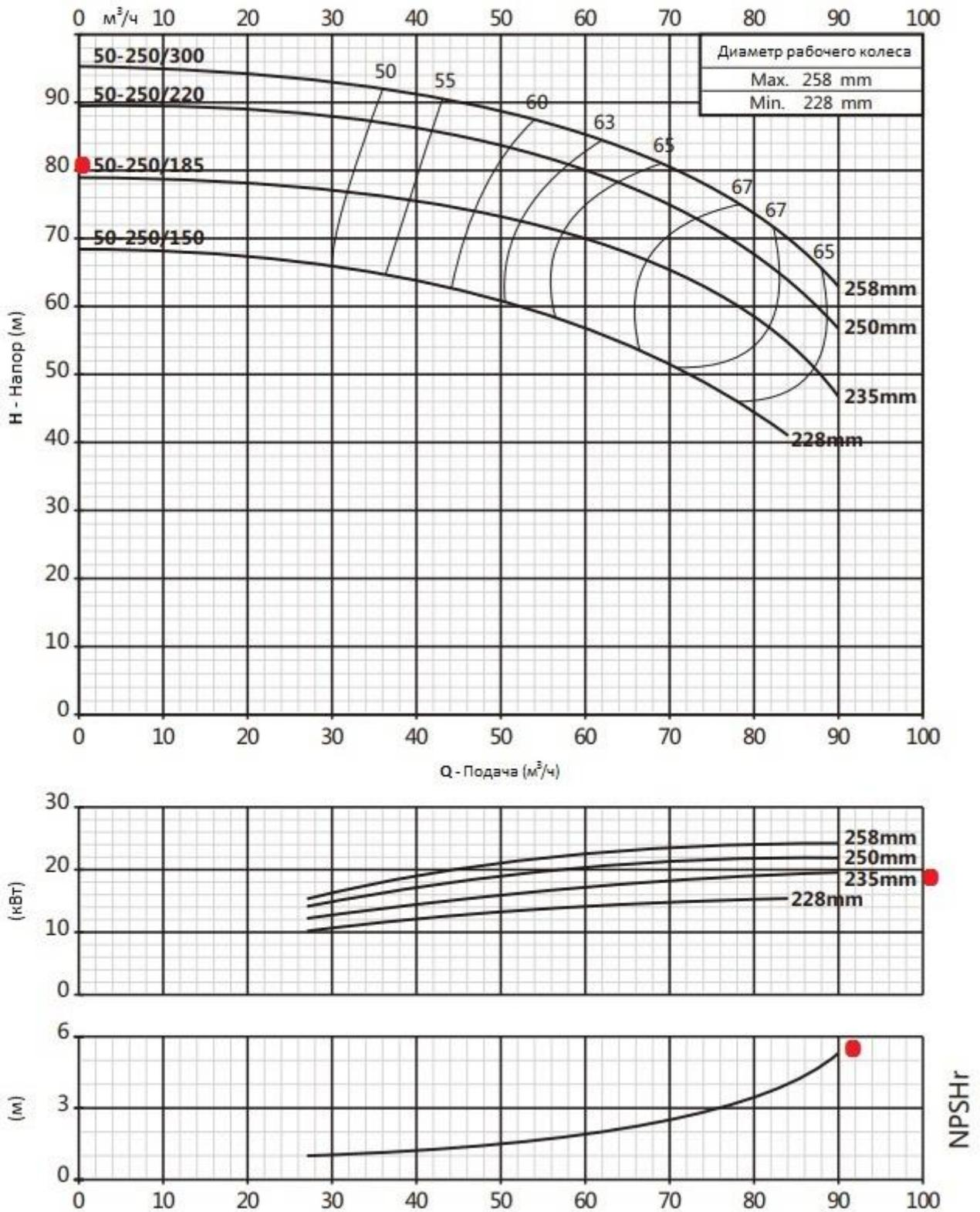
Пояснение к графикам: Н – напор в м.в.с., Q – подача в м³/ч, NPSHr – потери давления на всасывании, кВт – потребляемая мощность в кВт. Измерения проводились для чистой воды, температурой 20°С и вязкостью 1 мм²/с
